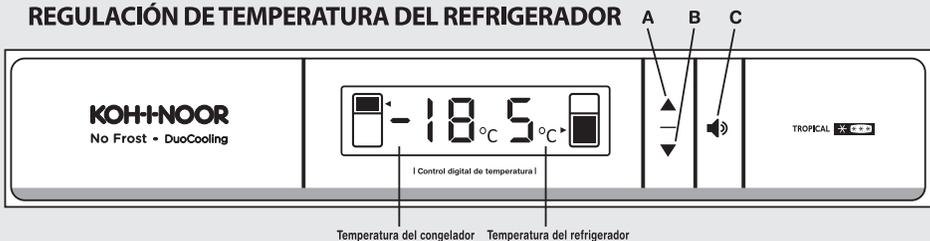
La unidad está equipada con un sistema de control electrónico de la temperatura ubicado en la parte superior de la heladera y al cual se accede abriendo la puerta del Congelador.
